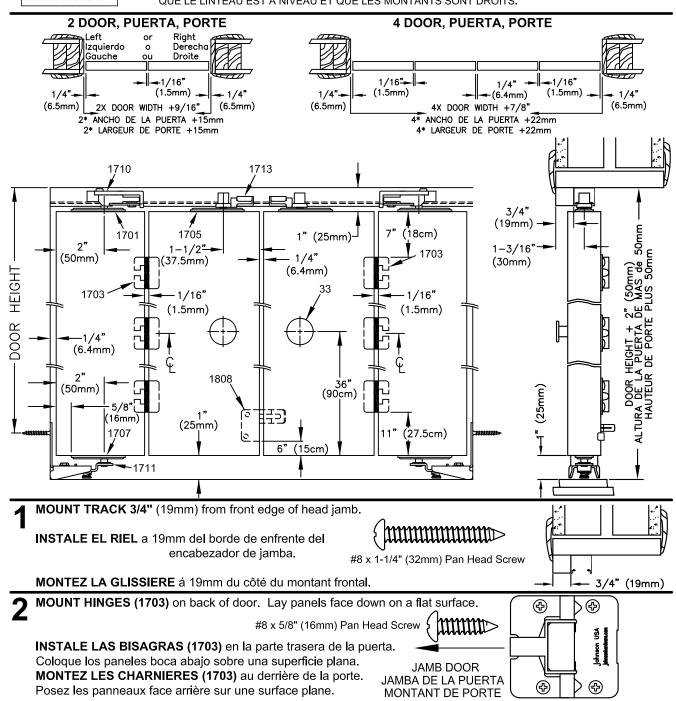
**FASTEN PIVOT PLATES** to top and bottom of doors as shown. COLOQUE LAS PLACAS GIRATORIAS arriba y abajo de las puertas como se muestra. FIXEZ LES PLAQUES DE PIVOT au haut et au bas des portes, comme indiqué ci-contre.
